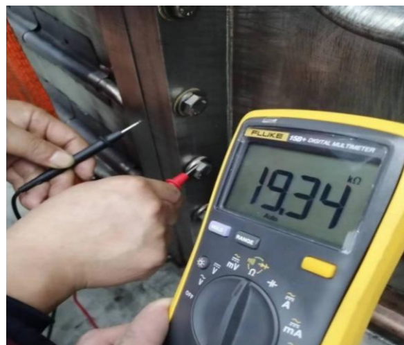
图 2.1.1.2 连接处绝缘失效
