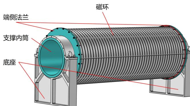
图 1 单个子缓冲器磁芯结构
